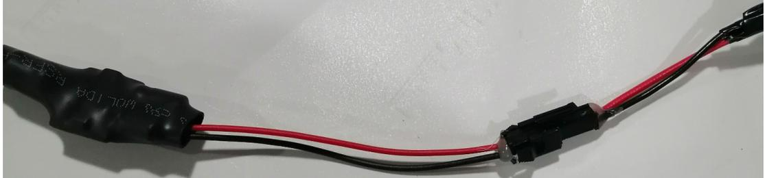
降压器SM-2Y插件红色正极、黑色负极，连接连接线SM-3A插件红色正极、黑色负极线
