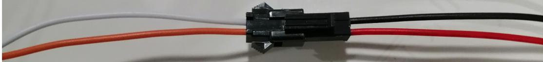
控制器SM-2Y插件，橙色刹车灯正极、白色刹车灯信号连接刹车灯降压器SM-2A插件，红色正极、黑色负极
