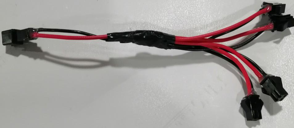
连接线SM-2A插件红色正极、黑色负极连接尾灯降压器SM-2Y
