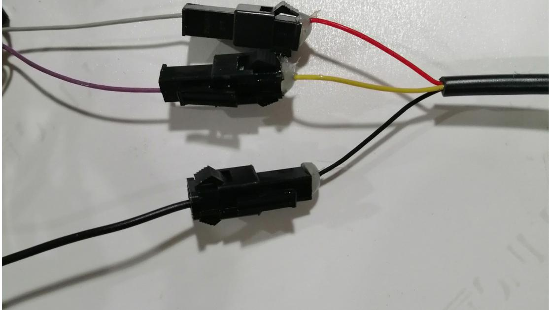
大灯连接线SM-2Y红色大灯信号线连接总线SM-2A插件
