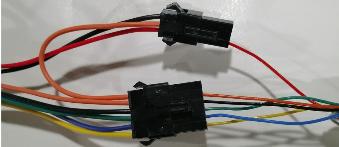
控制器SM-6Y插件，橙色预留、橙色电门锁、黑色负极、绿色仪表转把信号、蓝色、黄色仪表通信线连接总线SM-6A插件橙色、黑色、绿色、蓝色、黄色线；控制器SM-3Y插件橙色、黑色预留、红色仪表电源正极连接总线SM-3A插件红色线
